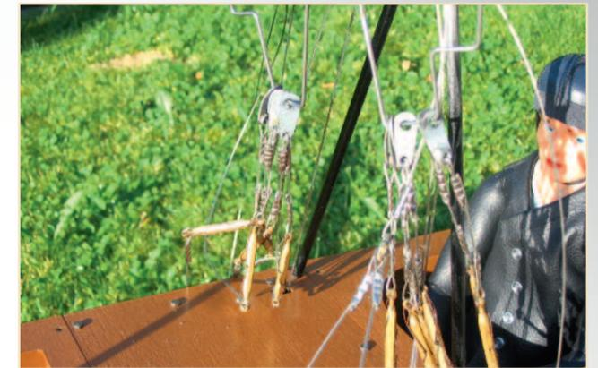
Sammellaschen der Tragflächen auf, die übereinander gelegt und mit zwei M3-Inbusschrauben fixiert werden. Für den hinteren unteren Spannturm wurden zwei 5 mm starke Stahldrähte zu einem Y hart verlötet, mit dem entsprechenden Rumpfspant vernäht und verklebt. Die Messingrollen laufen auf einer M5-Inbusschraube.
