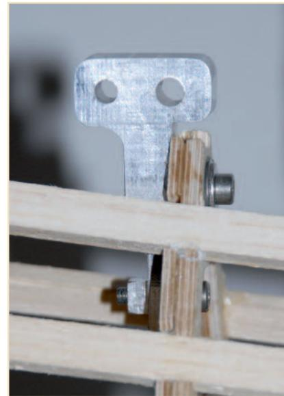
In dieses gefräste Aluminiumteil werden später die Fahrwerksdrähte eingeschoben. Noch haben die Löcher Übermaß, damit man die vorgebogenen Teile einführen kann. Bei der Endmontage werden Messingbuchsen mit Flanschen von beiden Seiten aufgeklebt.
