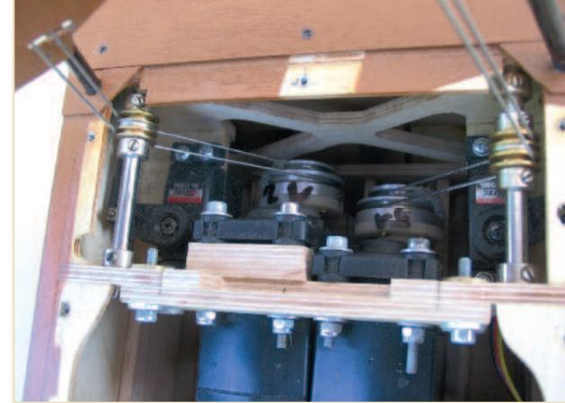
In der Mitte die Jumboservos C 12021 für die Flächenverwindung. Die Seilrollen wurden aus Alu gedreht und aufgeschraubt. Über die Messingrollen an den Seiten geht es zum oberen Spannturm. An den Seiten sind die Höhenruderservos zu sehen.
