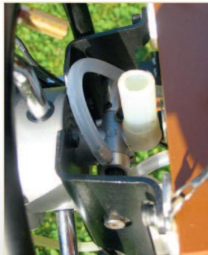
Ein paar Zentimeter Silikonschlauch sorgen dafür, dass nur ein Minimum an Treibstoff den Vergaser in die falsche Richtung verlässt. Der Aviateur ist froh darüber...
