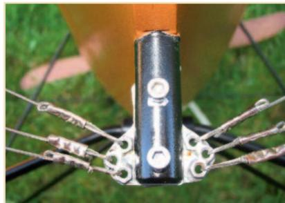
Im Schlitz eines Aluminiumdorns werden die unteren Sammellaschen der Vorderholme verschraubt.
